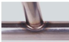
Giunto a T su tubo Inox Spess. 2 mm - 150A Pulse 10 Hz
