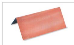
Saldatura ad angolo su Titanio Spess. 1,5 mm - 20A - Pulse 200 Hz
