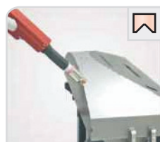
Cordone ad angolo Puntatura sull'involucro di un armadio elettrico
